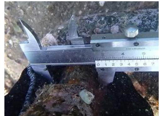
摩耗箇所の測定状況 \phi 27.2mm
