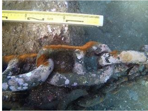
21 番シンカーチェーンの摩耗箇所。
