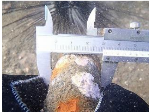
吊り筋の健全な箇所の測定状況 \phi 31.7mm
