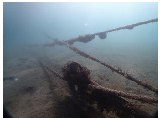
付近でみられたアンカーとロープとの交差接触状況
