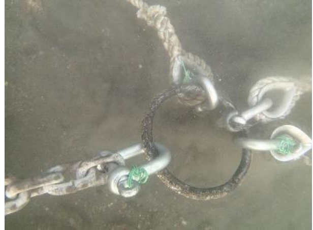
左方のシンカーから来たチェーン先のリングに3艇の繋留索が接続されている。
