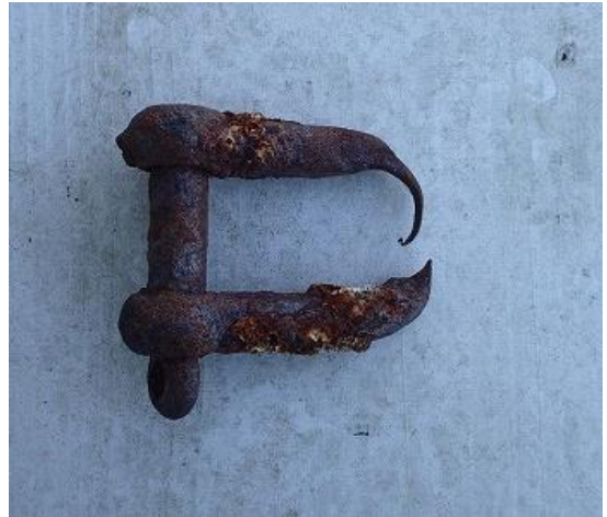
過日発生した係留シャックルの破断
