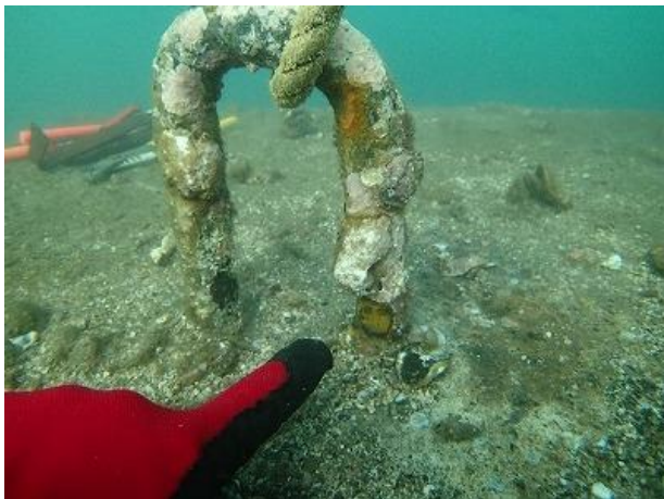
シンカーのU字金具摩耗状況 指先位置が摩耗している
