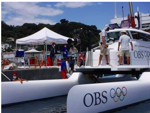
OBS カメラボート、左右のフロートと 操縦席は分解しコンテナで世界中に運ばれる
