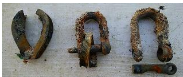
磨耗交換したシャックル、シンプルの例
